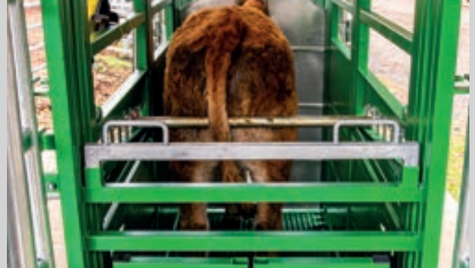
7 Het dier vastzetten van achteren door een fixeerstang
