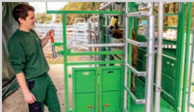
6 Heckschiebetür zum schnellen und sicheren Schließen
