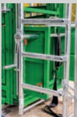
8 Puertas batientes en la puerta corredera trasera para el cuidado de los cascos
