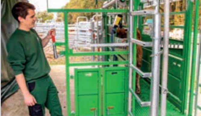
6 Schuifdeur achteraan voor snel en veilig sluiten
