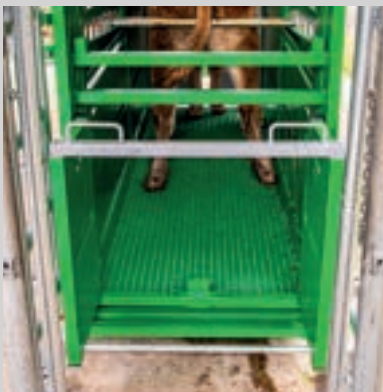
8 Klapdeur in de achterste schuifdeur voor hoefverzorging
