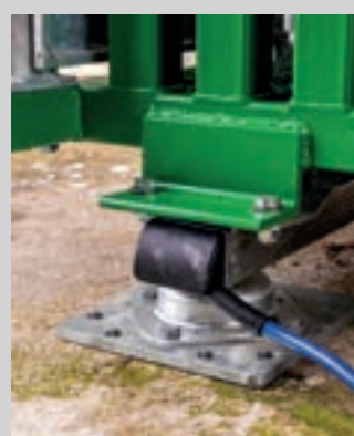
10 Plaques de montage intégrées pour barres de pesée HD5T
