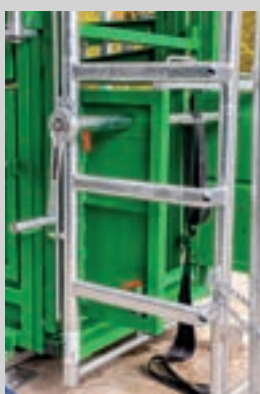
8 Portes rabattables intégrées à la porte arrière coulissante pour faciliter le soin des onglons
