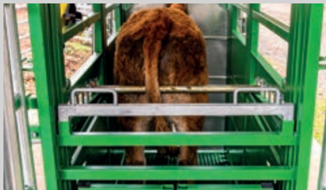
7 Fissaggio dell'animale da dietro tramite barra di fissaggio
